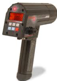
Slika 3.18. Prikaz radara kojim se mjerila brzina lopte u testiranju
