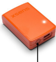
Slika 3.7. Senzor za mjerenje kinematičkih parametara i prijenos podataka
