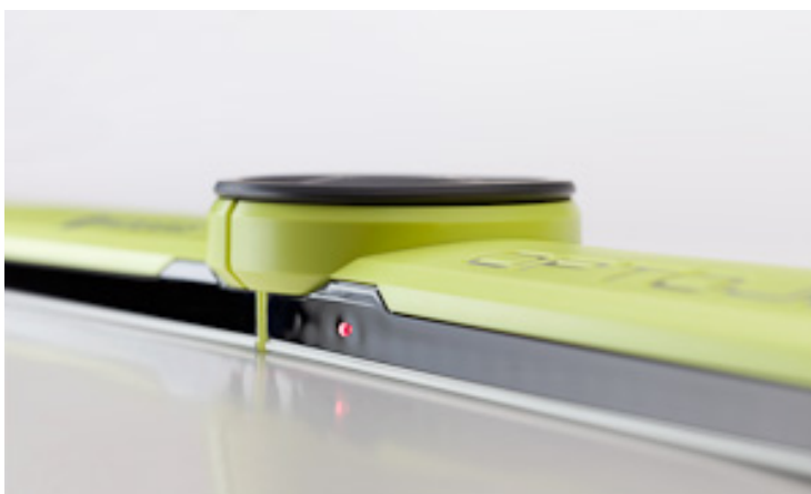
Slika 3.13. Optojump_next sustav za mjerenje parametara kontakta stopala s podlogom
