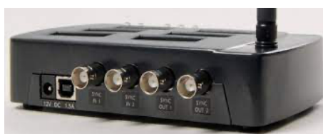
Slika 3.8. Stanica za primanje kinematičkih podataka i prijenos prema računalu
