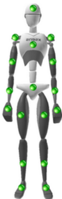
Slika 3.9. Prikaz pozicija senzora na tijelu ispitanika
